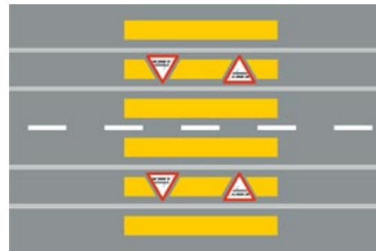
Eine Tram-Markierung auf dem Fussgängerstreifen.
